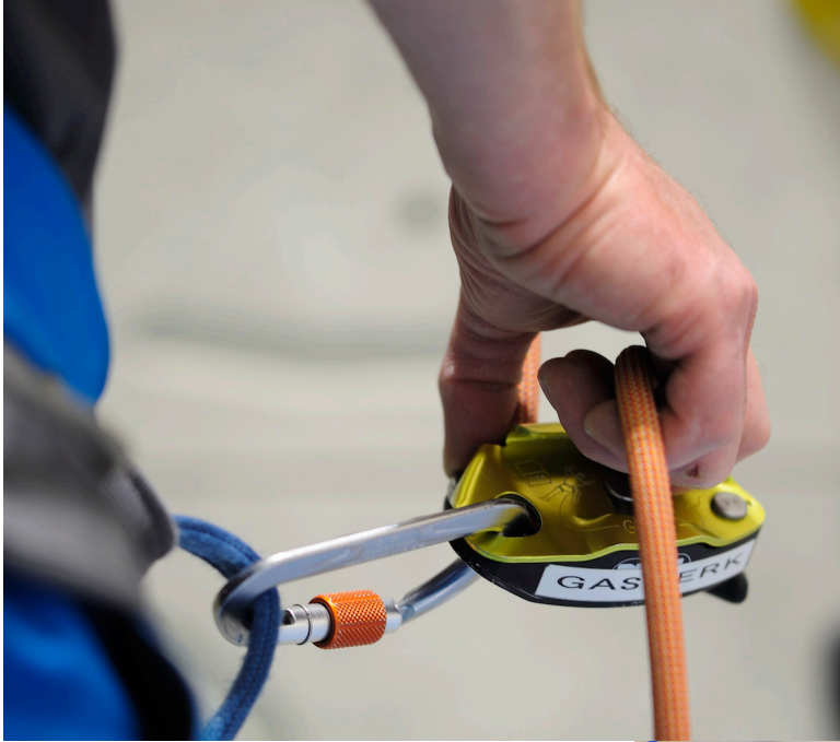
Abb. 5 Fehlerbeispiel Halbautomat Grigri Bremshand im Offenmodus*, während die Sensorhand tunnelt. Der sensitive Kontakt mit dem Seil ist dabei ungenügend. Dadurch verlängert sich die Reaktionszeit. Damit ist der rechtzeitige Zugriff nicht immer gewährleistet.
